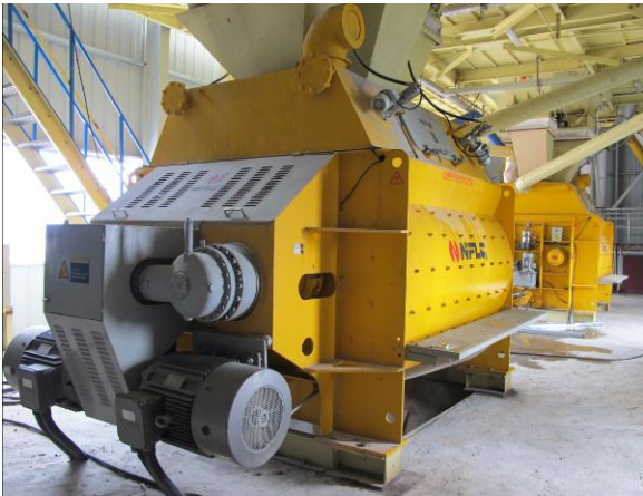
搅拌主机：南方路机专利的双螺带搅拌主机
